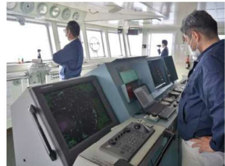
深江丸にAI操船支援システムを接続し大阪湾上で試験
