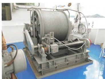
写真 5 光複合アーマード ケーブルウインチ
