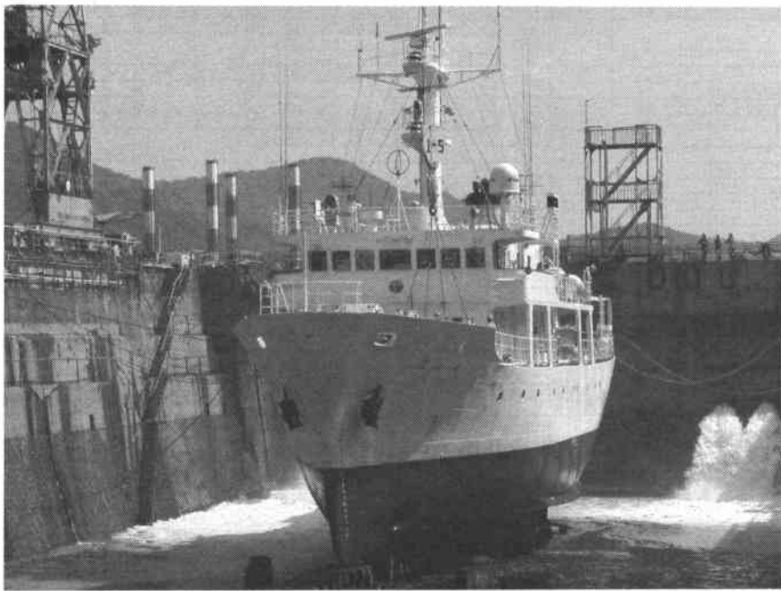
深江丸合入渠工事 船体・機関整備完了、ドライドック浮上直前の深江丸 入渠地：アイ・エイチ・アイ アムテック 相生工場
