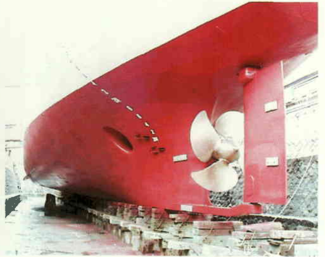
〔 入渠工事中の深江丸（船体整備、塗装後の船首・尾 船底部） 〕
