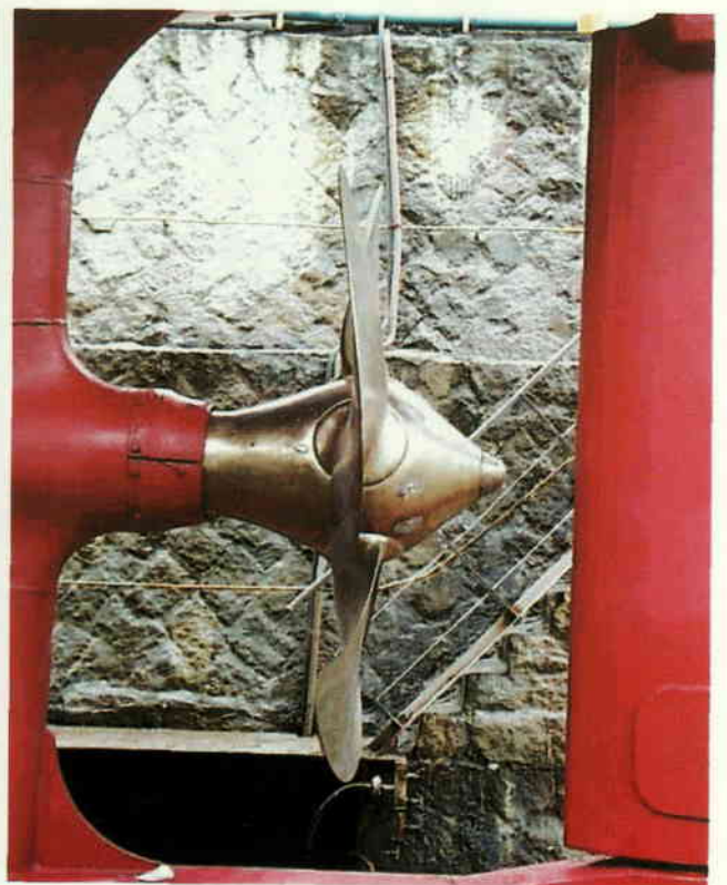
〔 研磨後の推進器 ピッチ角：-1度 〕
