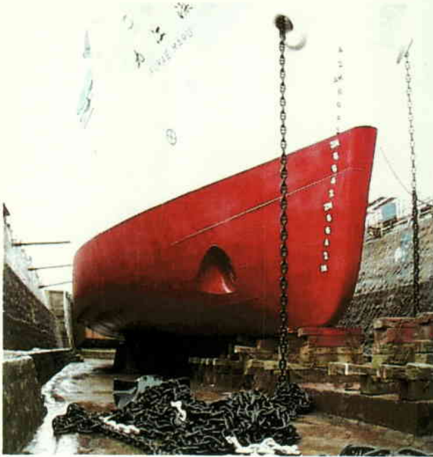
〔 入渠工事中の深江丸（船体整備、塗装後の船首・尾 船底部） 〕
